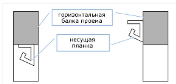
Несущая планка располагается горизонтально. Один из концов ПВХ пленки закрепляется между прижимными планками с помощью заклепок. Далее отрезается с помощью острого ножа с таким расчетом, чтобы при установке полосы на несущую планку, ее нижний конец не доходил до поверхности пола на 2,5-3 см, пленка за несколько дней немного провиснет. В противном случае полоса может быть оборвана,
