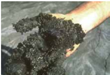
Matrox®: материал футеровки для липких сыпучих материалов
