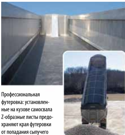
Карьерная техника: футерованный листами Matrox® X кузов самосвала для перевозки руды в Австралии
