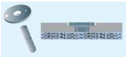
Надежное крепление: шпилька с резьбой приваривается к основанию через предварительно просверленную плиту
